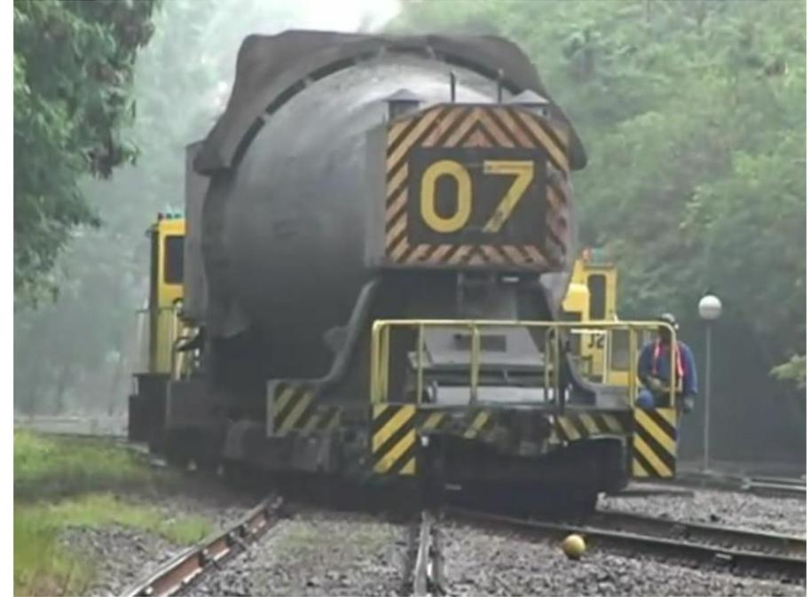
**1.** Nell'altoforno i minerali del ferro si sono fusi ed hanno prodotto la **ghisa liquida**, una **lega** di **Ferro** e **Carbonio**; il Carbonio ha una quantità compresa tra l'**1,9%** ed il **4%**, il resto è quasi tutto Ferro.
