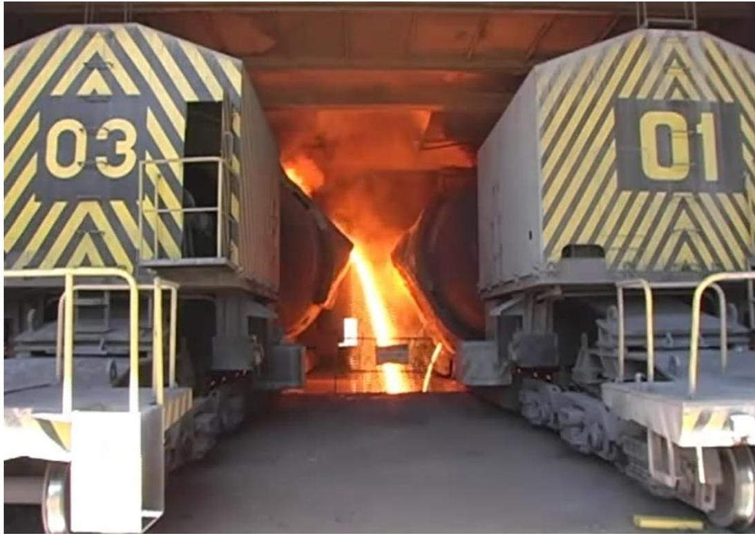
**3.** Entrato nell'acciaiera il carro-siluro ruota e versa la ghisa liquida dentro la **siviera**, un enorme contenitore rivestito in materiale refrattario che poi viene sollevata da una enorme gru.
