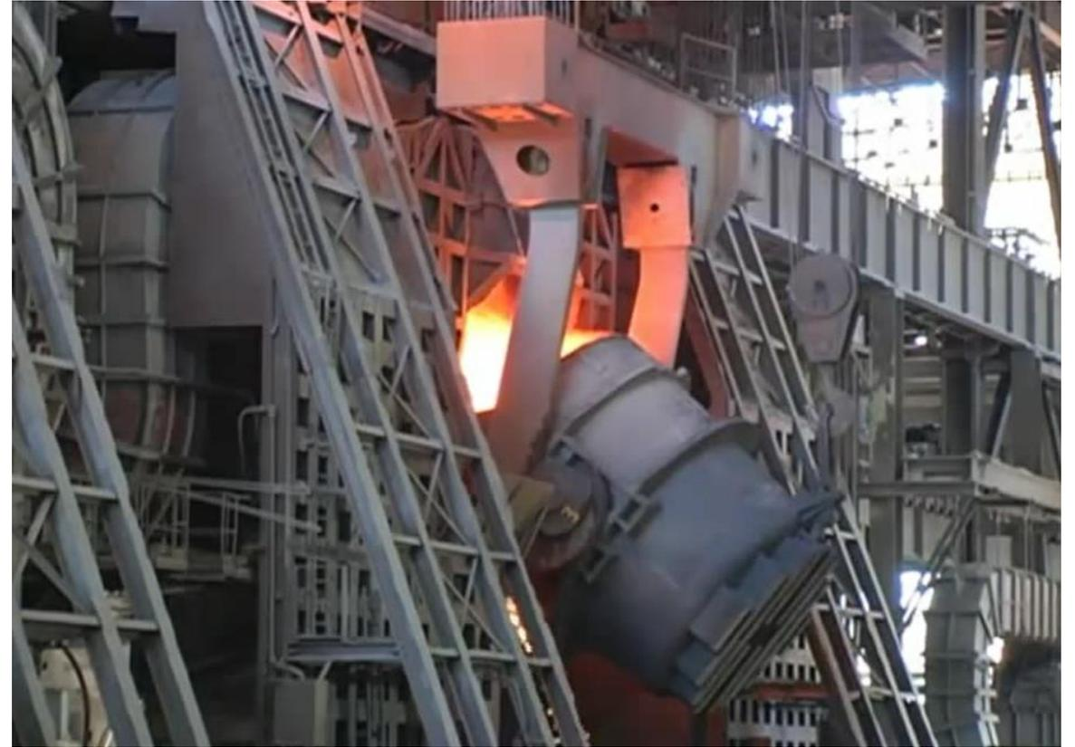
5. La siviera ruota e cola la ghisa fusa nel Convertitore a ossigeno. Qua la ghisa viene convertita in **acciaio**, una lega di Ferro e Carbonio in cui la quantità di **Carbonio** è **inferiore all'1,9%**.
